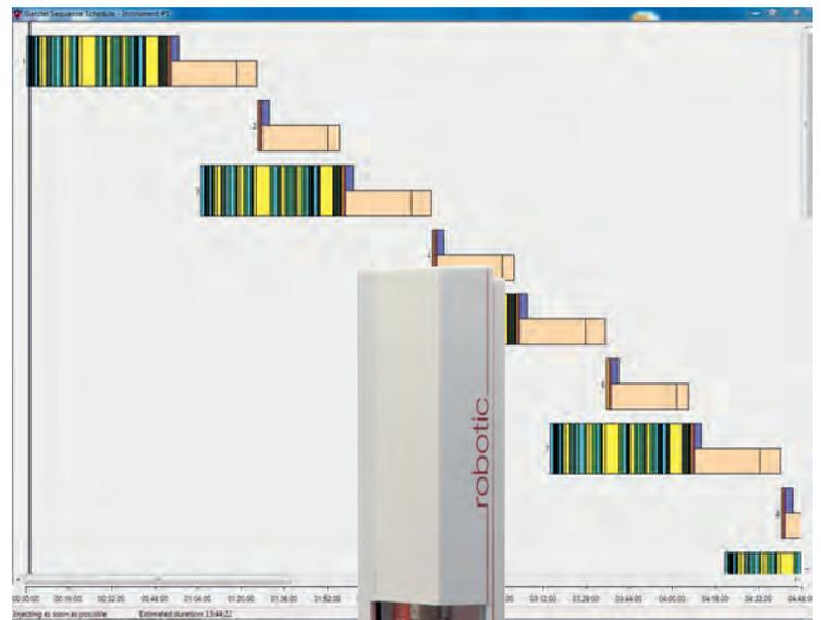
Die Scheduler-Ansicht in der MAESTRO-Software zeigt den zeitlichen Ablauf von Probenvorbereitung und Analyse. In 24 Stunden lassen sich 24 Proben nach dem Differenzverfahren bestimmen. Das entspricht insgesamt 48 Analysenläufen.
